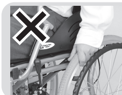
①駐車ブレーキのロックを解除します。
