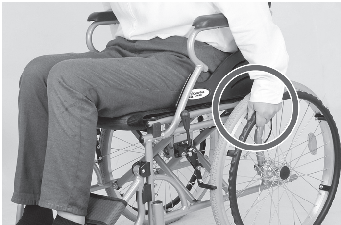
②ハンドリムを握り車輪を回転させ移動します。
