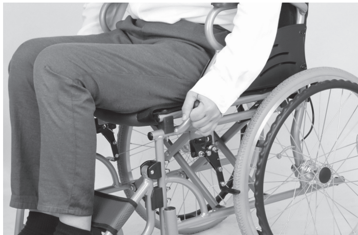
①駐車ブレーキのロックを解除します。
